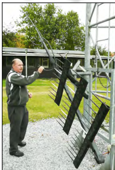
Doordat de prang kan draaien kan deze gemakkelijk gevuld worden
