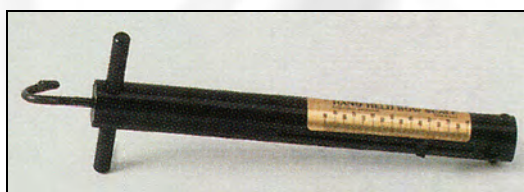
Een boog “unster” voor de trekkraft meting
